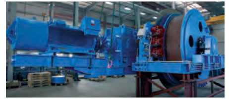
Zusammenbau eines Förderhaspels für eine Hauptseilfahrtanlage.
