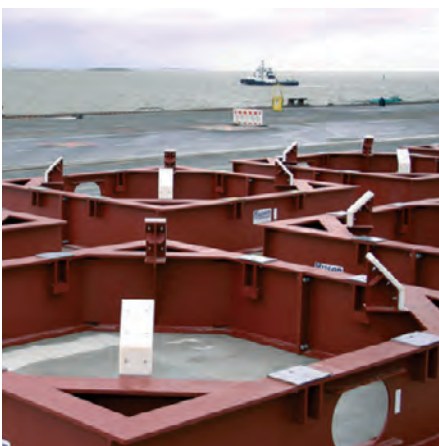
Aufnahmeelemente für Offshore-Windkraftanlagen am Ausrustungskai in Bremerhaven.
